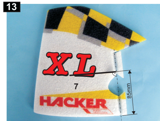
13 Do směrovky 7 vyřízněte drážku pro páku 23. Cut the slot in the rudder 7 for control horn 23.
