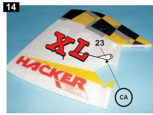
14 Vložte páku 23 do drážky, zalepte ji vteřinovým lepidlem a zastříkejte aktivátorem. Glue in place control horn 23 with CA and CA kicker.
