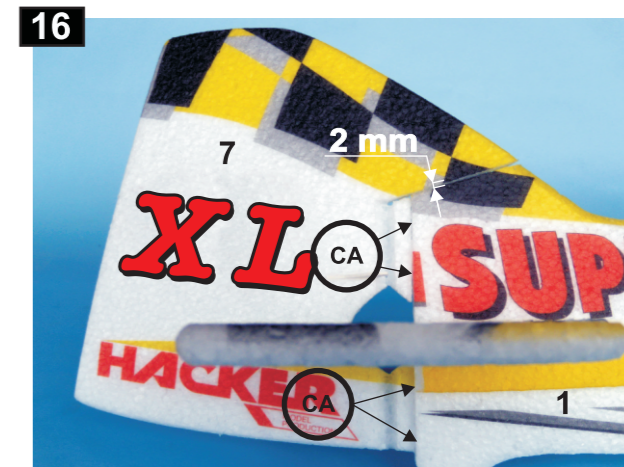
16 Na označené místo přilepte směrovku 7 vteřinovým lepidlem a zastříkejte aktivátorem. Glue in place rudder 7 with CA and CA kicker.
